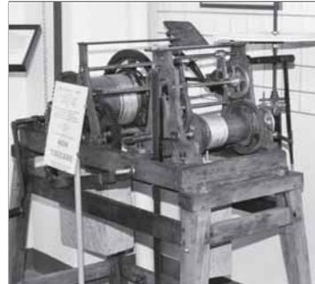
rale sono costituiti da una ruota dotata di speciali denti su cui si inserisce un meccanismo solido all'asse del pendolo. Il nostro orologio è dotato di scappamento "ad ancora". Lo scappamento fa sì che quando il pendolo si trovi ad una estremità del suo percorso venga spinto nella direzione opposta, e contemporaneamente la ruota dentata avanzi di uno scatto.
